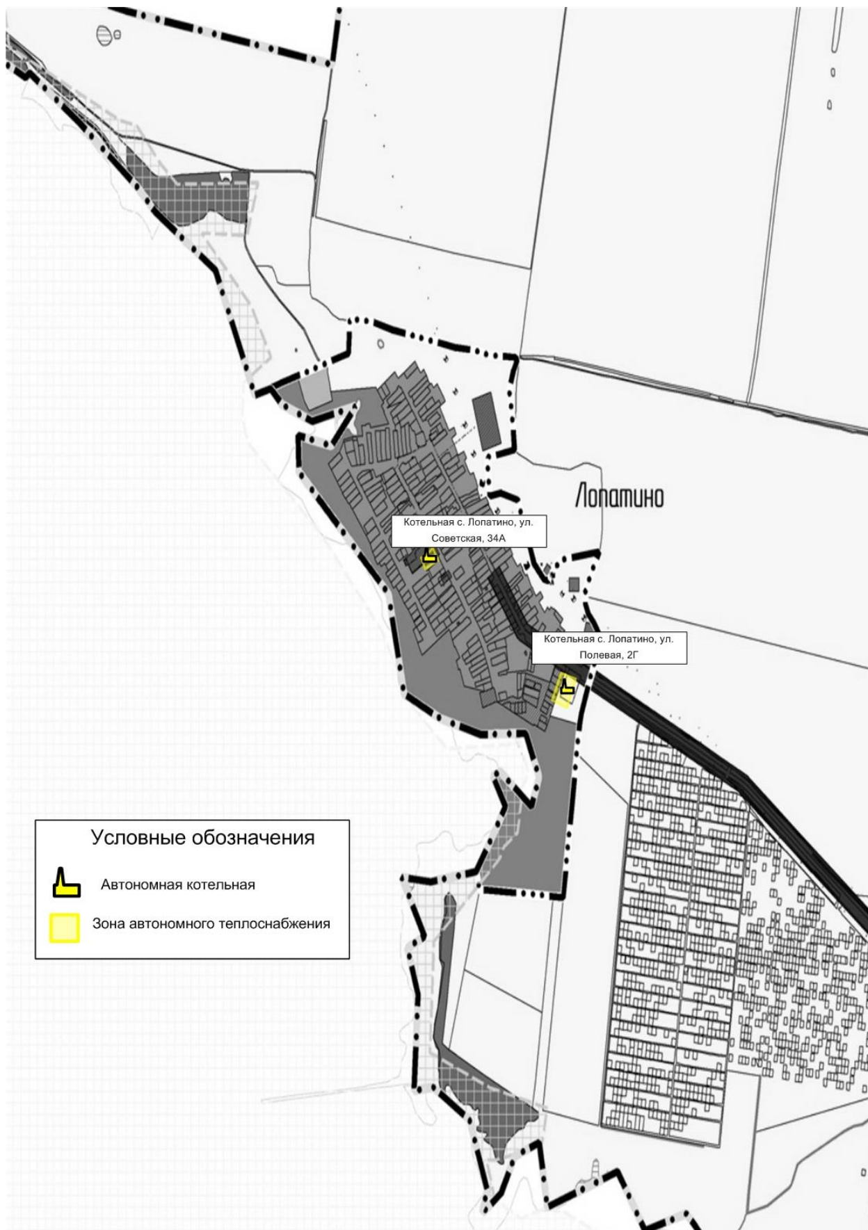
Рис. № 1.4.2 - Зоны действия независимых систем теплоснабжения на базе автономных котельных на территории с. Лопатино
